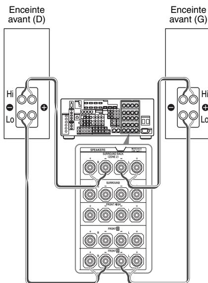
Raccordez les prises du côté Lo (ou Hi) des enceintes avant aux bornes FRONT A et raccordez les prises du côté Hi (ou Lo) des enceintes avant aux bornes SURROUND BACK/FRONT HIGH/FRONT B/ZONE 2. Assurez-vous que les ferrures métalliques de Hi/Lo fixées aux enceintes ont été retirées des enceintes pour éviter tout dysfonctionnement de l'ampli-tuner.
