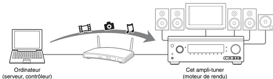
Commandez cet ampli-tuner à l'aide d'un contrôleur DLNA.
