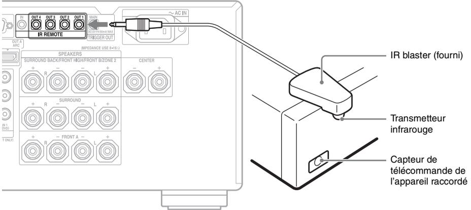
Placez l'appareil et le IR blaster comme suit quand vous voulez actionner plus d'un dispositif avec le IR blaster.
