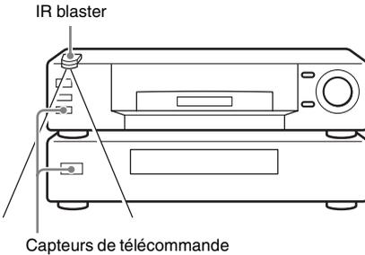
Si les capteurs de télécommande sur plus d'un dispositif ne s'alignent pas tel qu'indiqué dans l'illustration ci-dessus, utilisez un autre IR blaster (fourni) et une autre prise IR REMOTE OUT.
