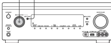
**1** Sélectionnez la source d'entrée avec **INPUT SELECTOR** sur l'ampli-tuner.
