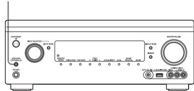
Appuyez plusieurs fois sur SPEAKERS (OFF/A/B/A+B) pour sélectionner les enceintes avant que vous désirez utiliser. Vous pouvez confirmer le jeu de bornes (A ou B) qui est sélectionné en cochant les indicateurs correspondant dans l'afficheur.
